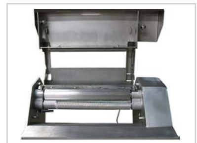
Capot de fermeture en une pièce, pourvu d'un interrupteur magnétique qui arrête la machine si le couvercle est levé pendant l'épluchage.
