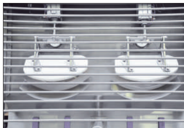
Discharge outlets of PSS SOM
