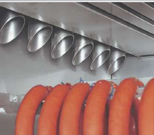
Ausblasdüsen blow-out pipes
