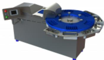
Machine conçue autour d'un plateau rotatif sur lequel sont positionnés 6 alvéoles amovibles sans outillage. Chaque alvéole permet la production de 4 à 6 brochettes en simultané. Différentes catégories d'aliments peuvent être envisagées telles que les viandes, poissons, légumes, fruits et autres produits élaborés.
