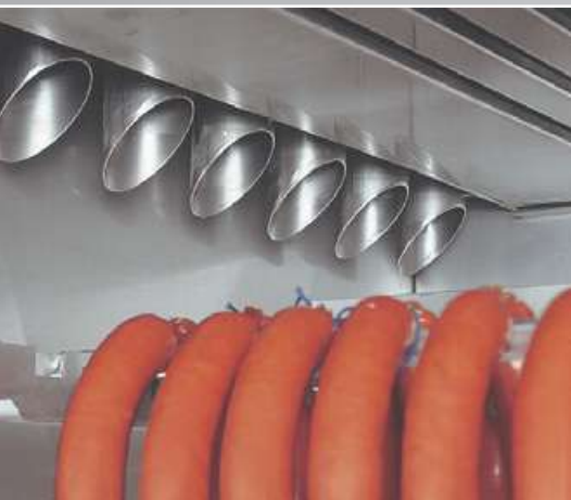
Ausblasdüsen blow-out pipes
