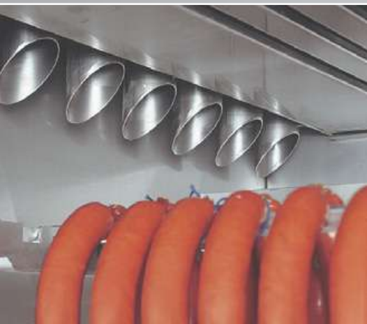
Ausblasdüsen blow-out pipes
