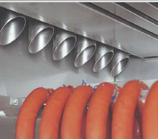
Ausblasdüsen blow-out pipes
