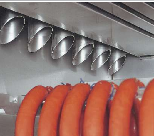
Ausblasdüsen blow-out pipes
