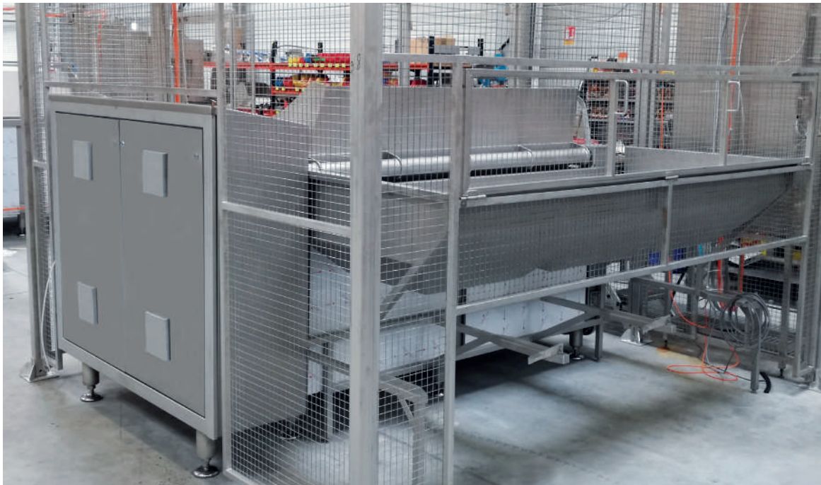
Cuiseur type 1500 Basculement panier par moto-réducteur Zone sécurisée
